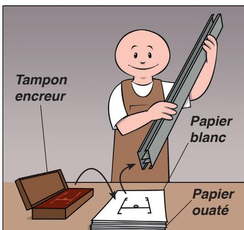
4. Encrez l'extrémité de la traverse de vantail avec un tampon encreur et réalisez plusieurs empreintes sur une feuille de papier blanc placée sur une pile de 5 épaisseurs de papier ouaté.
