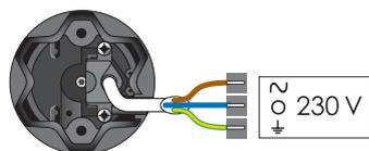
Mettre le moteur sous tension
