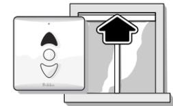
e) Appuyer sur le bouton montée et laisser le volet s'arrêter de lui-même
