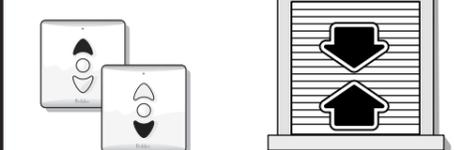
Le volet roulant est réglé sur le 2<sup>ème</sup> émetteur ou sur l'émetteur de commande générale
