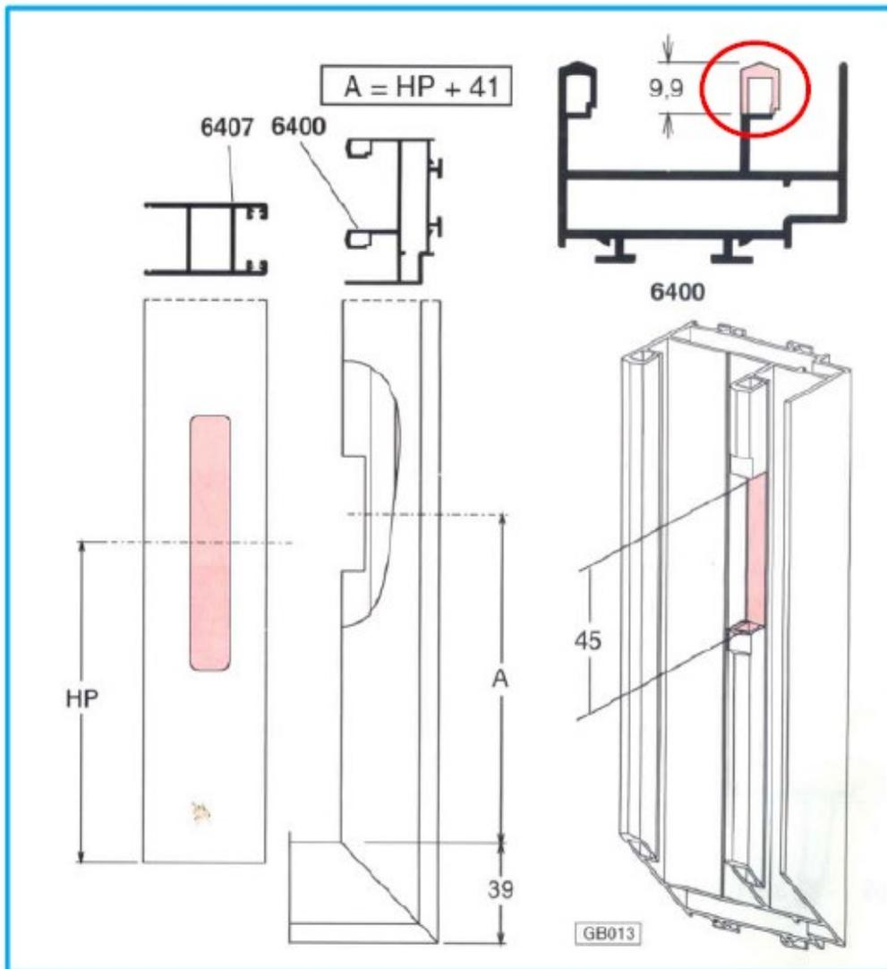
Pas d'usinage lors d'un dormant cage ouverte mais repositionner la gâche plus haute de 35mm.
