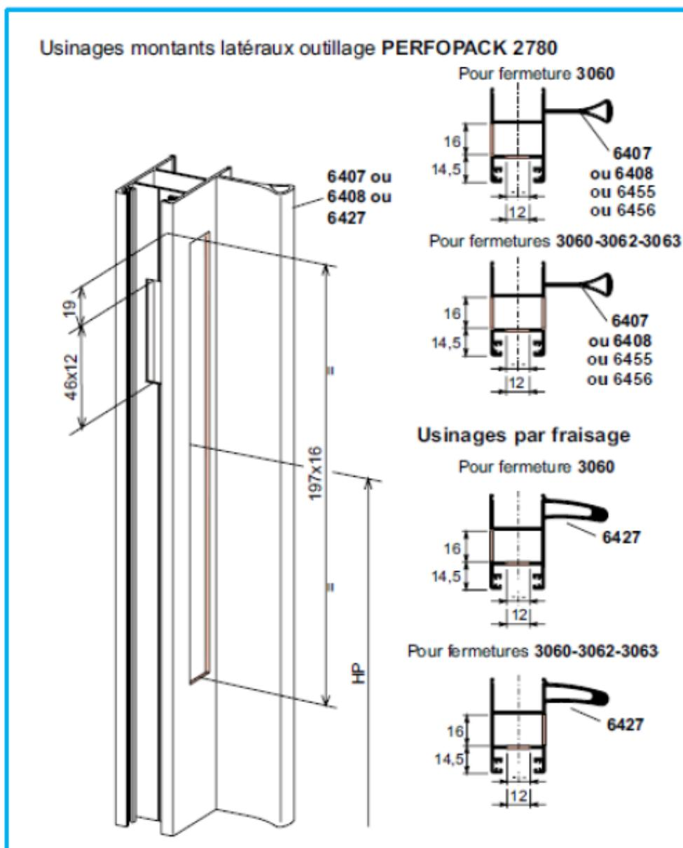
Un usinage supplémentaire est nécessaire pour le positionnement de la gâche lors d'un dormant cage fermée.
